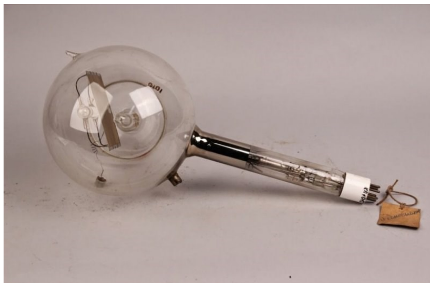
Иконоскоп конструкции В. К. Зворыкина
